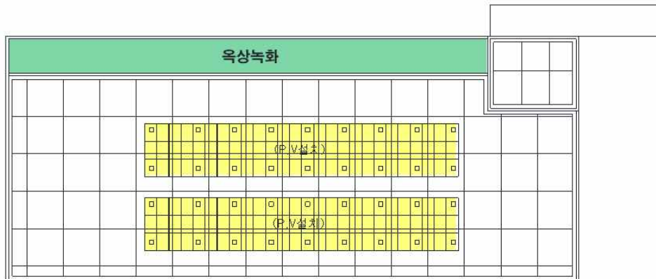
[그림 IV-12] 체육관 지붕 신재생에너지 및 옥상녹화계획
